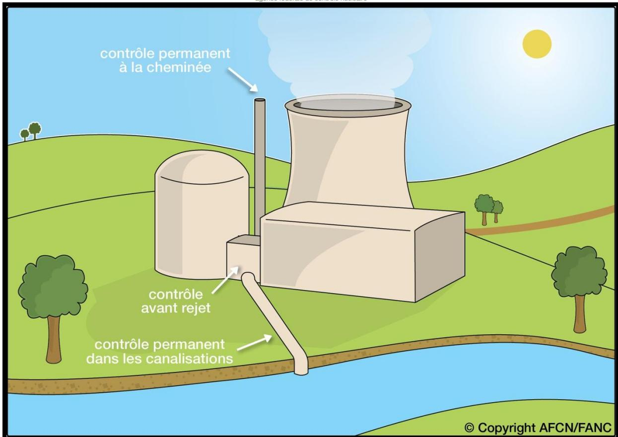
Figure 16 : Les contrôles des rejets par les exploitants
