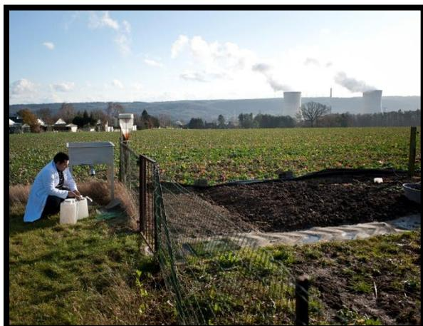
Figure 19 : Prélèvements d'eau de pluie par l'AFCN au voisinage du site de Tihange
