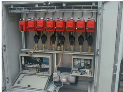
La récolte des poussières de l'air se fait à l'aide de pompes, l'air passant à travers un filtre qui arrête les poussières (photos de gauche – système automatique).
