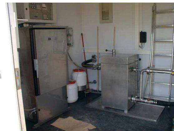
À l'extrême gauche sur la photographie, un échantillonneur automatique programmable (Buhler type PP MOS) permettant le pompage d'eau dans des flacons à des fins d'analyses de spectrométries gamma, alpha et bêta en laboratoire (sert au programme de surveillance radiologique du territoire).
