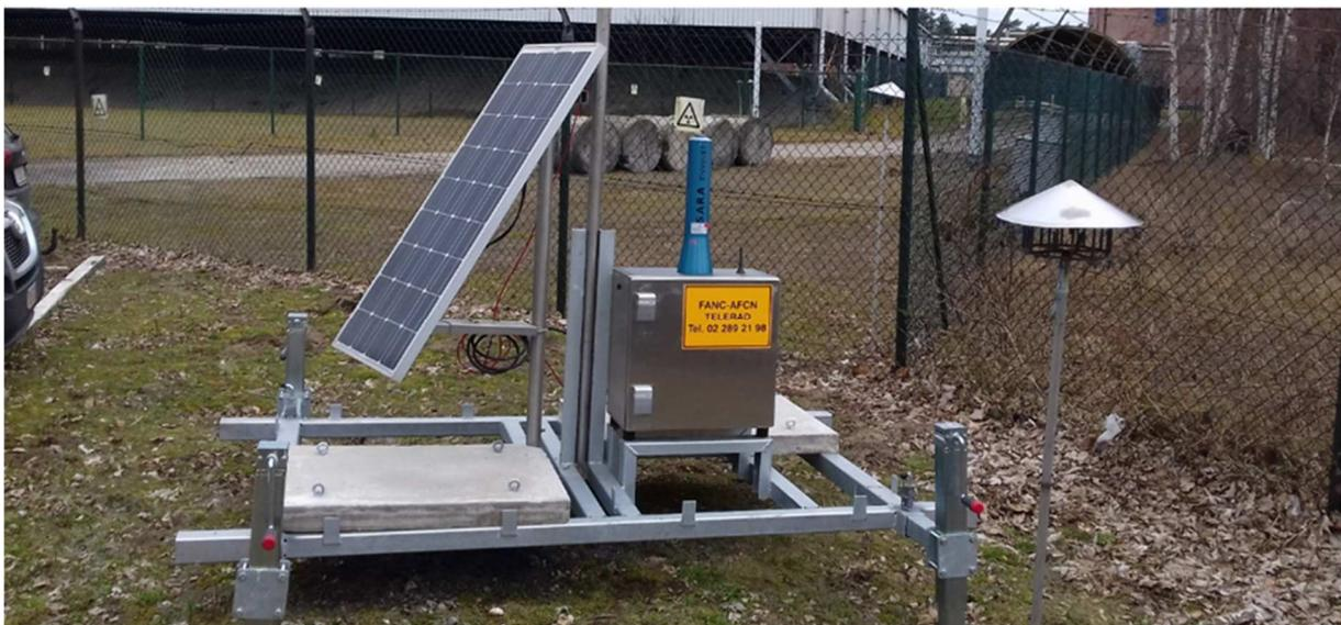
Les **stations de mesures aérosols** (détecteur ZnS) au nombre de 7 pour la mesure de la radioactivité des poussières en suspension dans l'air (aérosols et fines particules) qui déterminent la radioactivité alpha totale et bêta totale.
