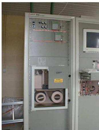
La photographie de gauche illustre l'unité de mesure alpha/bêta avec vue sur le ruban filtre déroulant qui reçoit les poussières et les particules de l'air.
