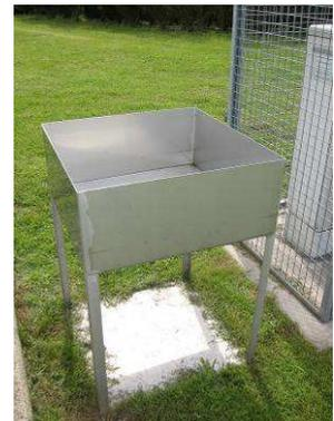
Les poussières sont également récoltées dans des bacs de dépôts où elles sont piégées par une fine lame d'eau répartie sur une surface connue (photo de droite).
