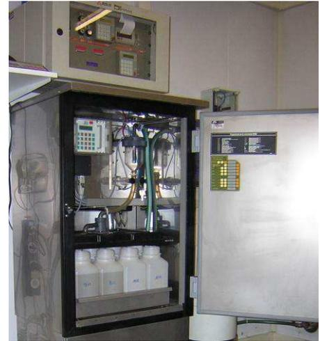
À gauche de l'unité de spectrométrie gamma se trouve un échantillonneur de grand volume d'eau (de type SwedMeter) qui permet un prélèvement automatique d'eau sur la conduite dès qu'un niveau d'alarme est dépassé. Cette eau est stockée dans une tourie de 25 litres à des fins d'analyses de spectrométrie gamma (et bêta) ultérieures en laboratoire.
