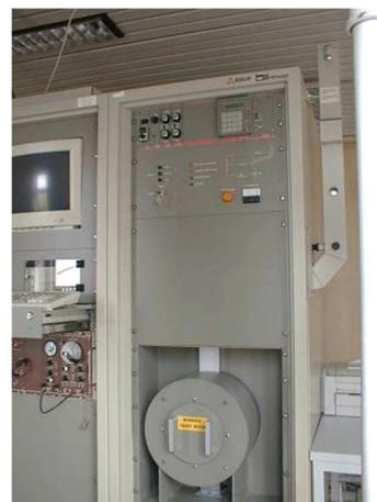
photographie de droite montre le détecteur dans son blindage (cylindre) et le tube parallélépipédique contenant les cartouches de charbon actif (sur le côté droit)
